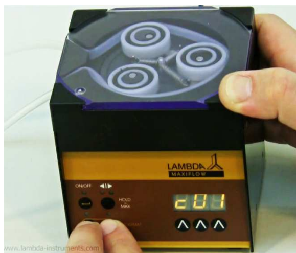
Obrázek 2-17 Zmáčknete současně tlačítko REMOTE a RUN . Na displeji se krátce zobrazí “c01” (cycle = cyklus). To znamená, že se program zopakuje jednou a pumpa se následně zastaví.
