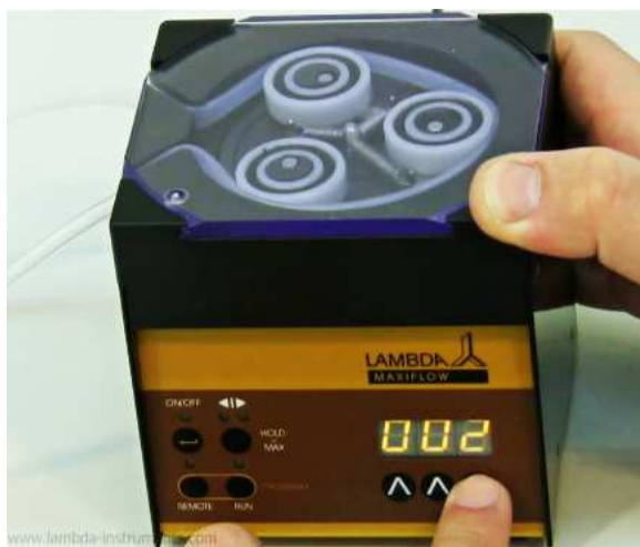
Obrázek 2-7 Nastavte požadovaný časový úsek pro první krok programu pomocí tlačítek \uparrow\uparrow\uparrow pod displejem (v rozlišení: 0–999 min. nebo 00.0–99.9 min.).
