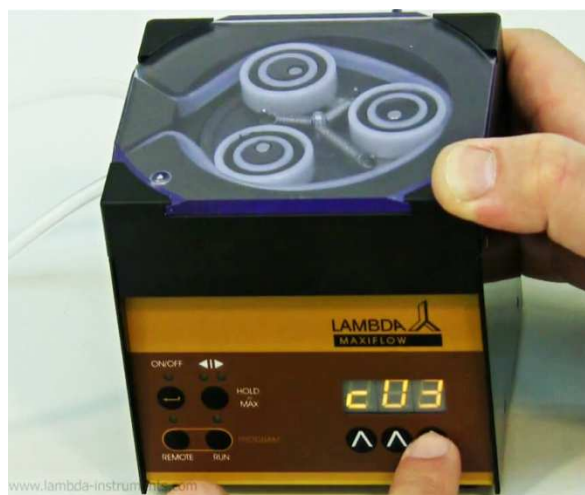
Obrázek 2-18 Pokud chcete, aby se stejný vámi nastavený program zopakovat třikrát, nastavte “c03” pomocí tlačítek Λ Λ Λ pod displejem (0–99 cyklů).
