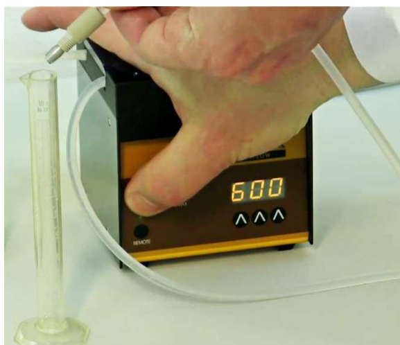
Obrázek 3-1 Zapněte pumpu a mějte konec hadičky v blízkosti odměrného válce, do kterého budete sbírat přečerpanou kapalinu po dobu 60 sekund.
