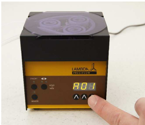
Obrázek 4-5 Pokud chcete změnit adresu pumpy, stiskněte tlačítka ^ ^ ^ pod displejem a nastavte nové požadované číslo adresy.
