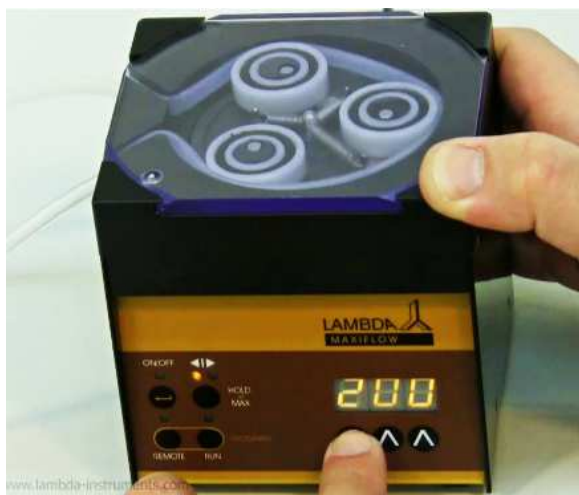
Obrázek 2-11 Vložte požadovanou hodnotu průtoku pro druhý krok programu.
