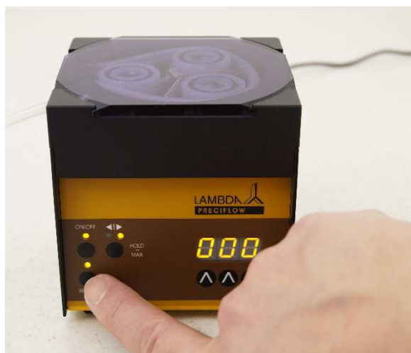
Obrázek 4-2 Stiskněte tlačítko REMOTE na předním panelu pumpy. Odpovídající LED dioda se rozsvítí a na displeji se ukáže přibližné napětí externího signálu.
