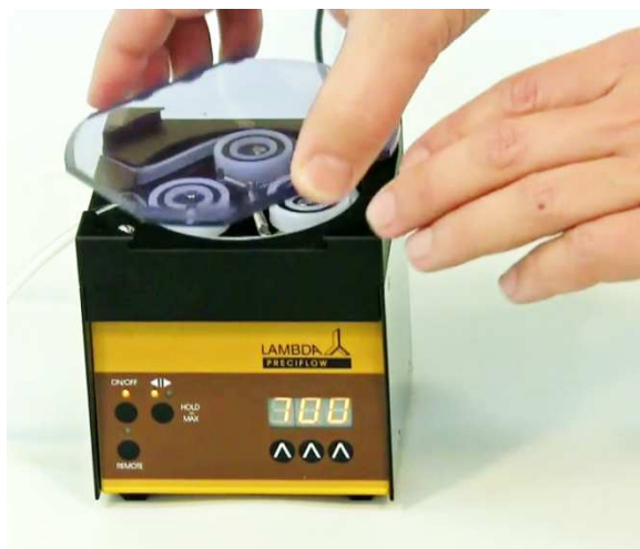
Obrázek 1-9 Uzavřete hlavu pumpy víčkem. Položte víčko soustředně křížem na střed hlavy, mírně přitlačte a otočte víčkem do strany.
