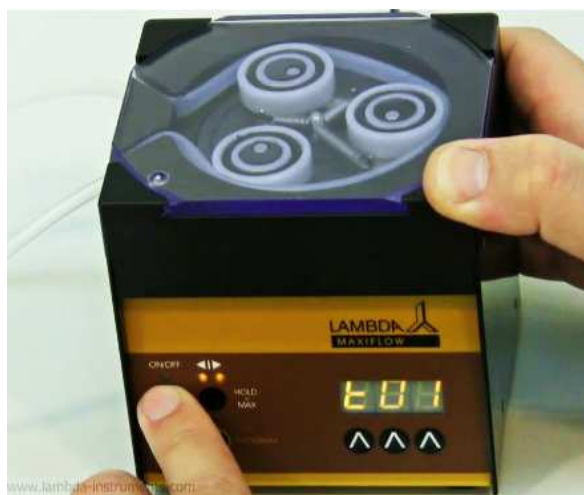
Obrázek 2-6 Pro potvrzení stiskněte tlačítko ON/OFF . Na displeji se objeví na několik sekund označení "t01" (time = čas) a nyní lze naprogramovat dobu v minutách pro průtok prvního kroku programu.
