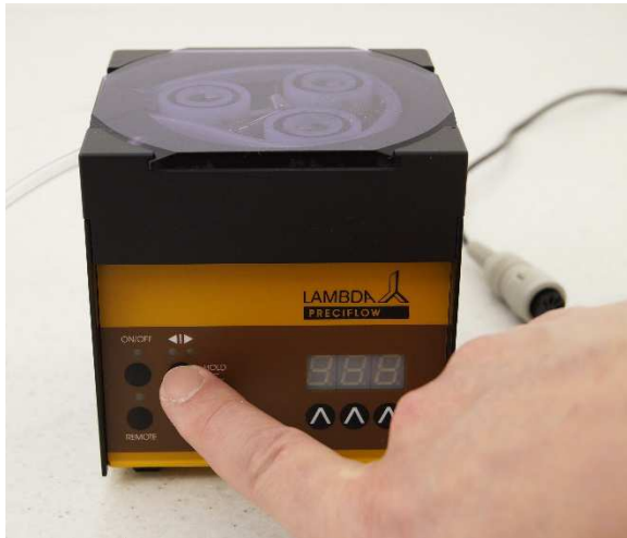
Obrázek 4-3 Odpojte pumpu z elektrické sítě. Při stálém stisknutí směrového tlačítka ◀▶ připojte pumpu znovu k síti.
