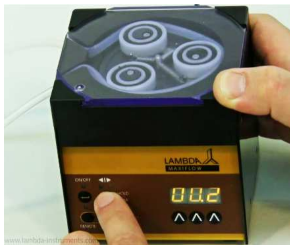
Obrázek 2-14 Stiskněte tlačítko ◀▶ pro volbu časového rozlišení.
