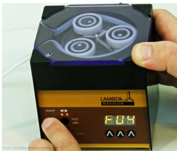
Obrázek 2-15 Po zadání hodnoty časového úseku posledního kroku znovu zmáčkněte tlačítko ON/OFF.
