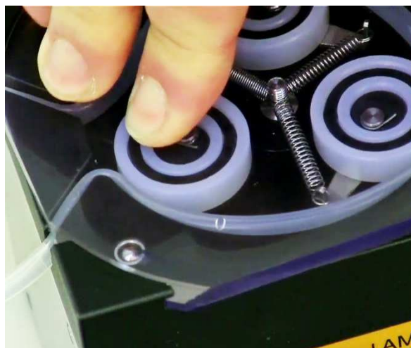
Obrázek 1-10 Otočte kryt tak, až jistící ocelová kulička v levém předním rohu pumpy zapadne do odpovídající prohlubně v krycím víčku.
