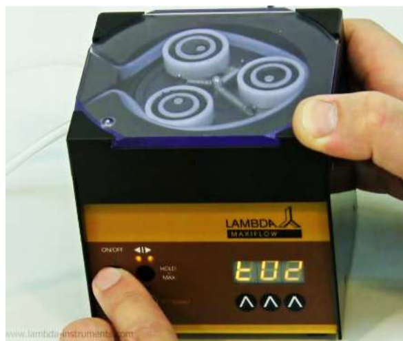
Obrázek 2-12 Pro potvrzení stiskněte opět tlačítko ON/OFF. Na displeji se zobrazí "t02".
