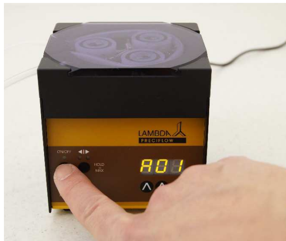
Obrázek 4-6 Pro uložení nové požadované adresy stiskněte tlačítko ON/OFF.
