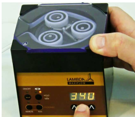
Obrázek 1-12 Každé z tlačítek Λ Λ Λ lze použít ke změně číslice k nastavení odpovídajícího průtoku.
