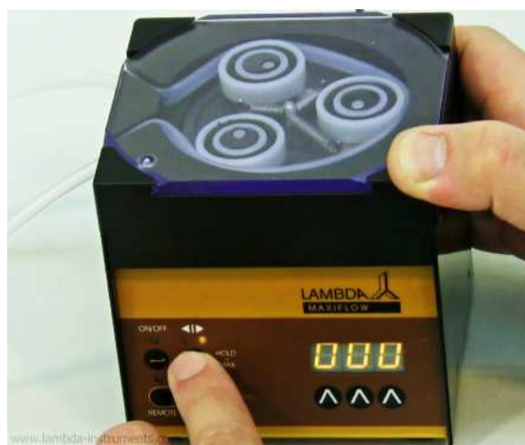
Obrázek 2-10 Zvolte si směr otáčení čerpadla pomocí směrového tlačítka \leftarrow\rightarrow pro následující průtok (rychlost otáčení).
