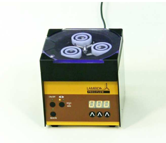
Obrázek 1-2 Zapojte napájecí zdroj do elektrické sítě (90-264V/50-60 Hz). Po krátkém zvukovém signálu se rozsvítí displej, na kterém se objeví předchozí poslední použité nastavení.
