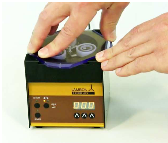
Obrázek 1-3 Otočte za současného přitlačení průhledný PVC kryt hlavy pumpy buď ve směru hodinových ručiček a nebo proti směru hodinových ručiček a vyjměte jej.
