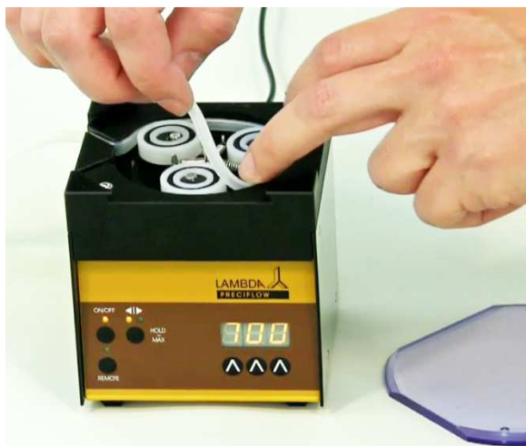
Obrázek 1-7 Klademe postupně hadičku před otáčejícím se přítlačným ložiskem, tak aby hadička byla volně zavedena po obvodu lože pumpy. Hadička by neměla být v žádném místě napnutá.
