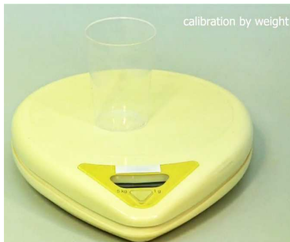
Obrázek 3-3 Zvažte hmotnost prázdné kádinky. Pro přesné zjištění hmotnosti přečerpané kapaliny vytárujte (vynulujte) váhy s kádinkou (např. 0,000 g).
