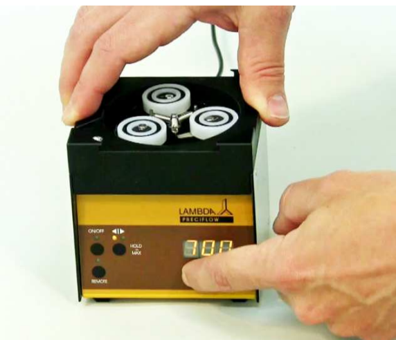
Obrázek 1-4 Rychlost otáčení zvýšte pomocí tlačítek "▲ ▲ ▲" pod displejem. Nastavte rychlost čerpadla na asi 700. Pro vložení hadičky je vhodné použít rychlost otáčení od 300 do 700.
