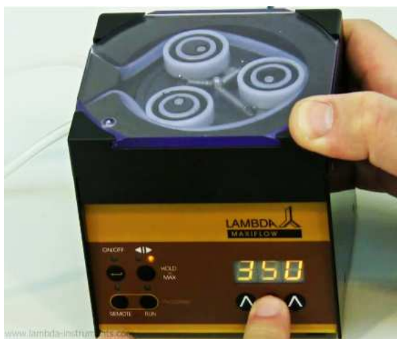
Obrázek 2-5 Pomocí tlačítek ▲▲▲ pod displejem nastavte požadovanou hodnotu průtoku pro první krok programu (od 0 do 999, což odpovídá 0 až 100 % rychlosti otáčení motoru).
