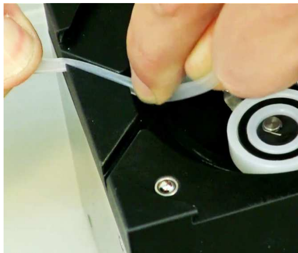
Obrázek 1-6 Vtlačte hadičku do vzdálenější drážky v hlavě pumpy. Tenké hadičky zasuňte až na dno drážky.
