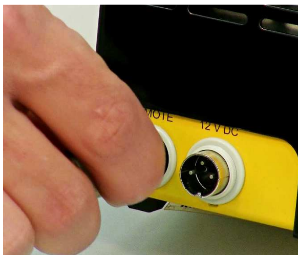
Obrázek 4-1 Pro dálkové ovládání pumpy zapojte 8-pólový kabel dálkového ovládání do konektoru "Remote" na zadní straně peristaltické pumpy.
