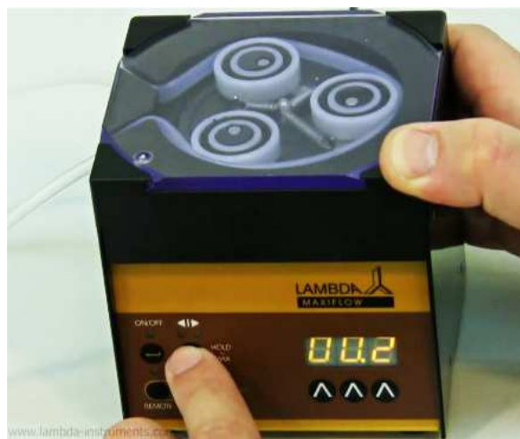
Obrázek 2-8 Stisknutím tlačítka \leftarrow\rightarrow , lze měnit časové rozlišení a to buď v minutách, nebo v 0,1 minut. V případě rozlišení v desetínách minut se zobrazí na displeji tečka např. "00.1". Časové rozlišení lze nastavit jednotlivě pro každý krok programu.
