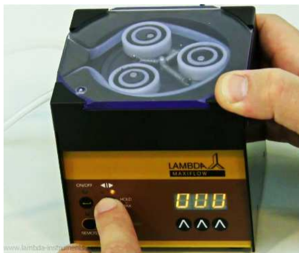
Obrázek 2-4 Nejprve zvolte směr otáčení pomocí směrového tlačítka \leftarrow \rightarrow .
